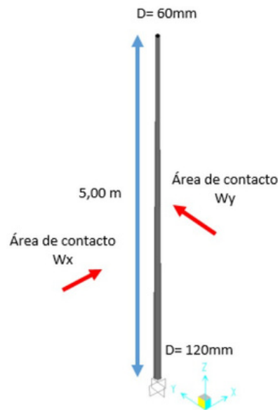
Figura 10.2.1: Áreas de contacto del viento a la estructura del poste (Fuente: Elaboración propia).
