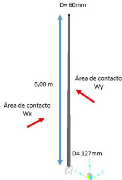
Figura 10.1: Áreas de contacto del viento a la estructura del poste (Fuente: Elaboración propia).
